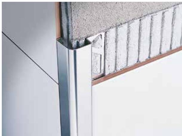
Roundcorner es un perfil de acero inoxidable redondeado para la protección de los bordes exteriores de las paredes de baldosas que se aplicarán durante la colocación para un acabado preciso "al ras" con el revestimiento. Protege y suaviza los bordes exteriores de las paredes. Ideal en ambientes públicos: cumple con los requisitos de las normativas sanitarias y de prevención de accidentes vigentes.
